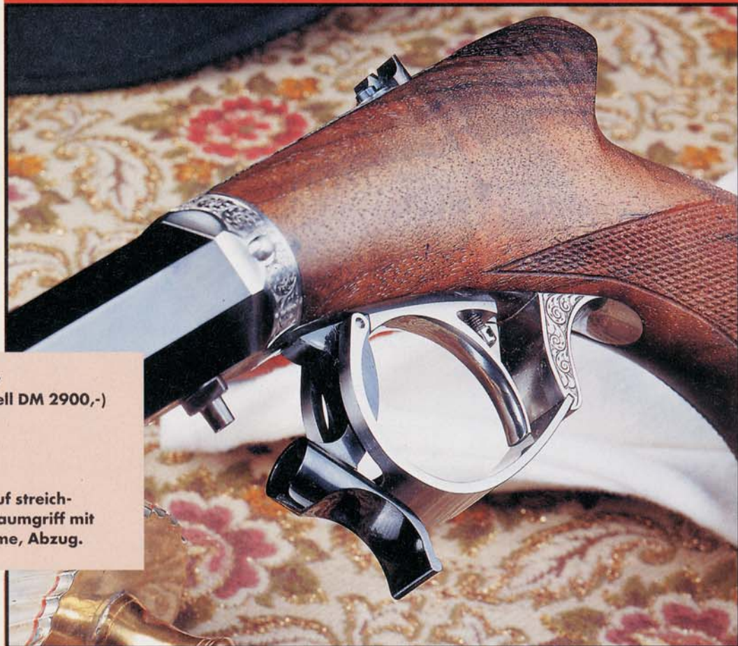
Der Hahn bewegt sich im Schlitz der Bügel-Schlagfeder, mit der er per kleinem Querstift gekoppelt ist. Die Schraube hinter dem Abzugszüngel dient als Triggerstop.
