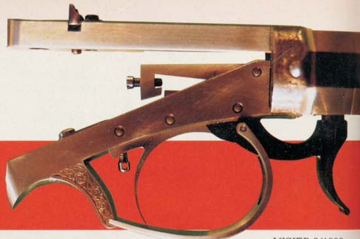
Der Rasteneingriff des Abzuges läßt sich über die kleine Stellschraube an dem L-förmigen Fangstück justieren. Die Trägerelemente des Schlosses bestehen aus zwei massiven, aus dem Vollen gearbeiteten Teilen, sie sind durch eine vor dem Abzugsbügel sitzende Schraube miteinander verbunden.
